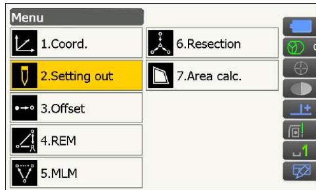
2. Задайте прибор и базисную заднюю точку для определения реперного направления. Выберите «Occupy setup» (Настройка места нахождения) на экране <Setting out> (Разметка). Введите данные для прибора и нажмите [OK] для перехода к настройке базисной задней точки.
