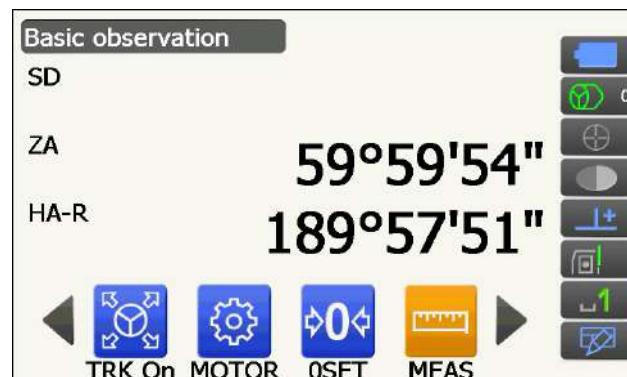
Начнутся измерения, отобразятся данные измеренного расстояния (SD), вертикальный угол (ZA) и горизонтальный угол (HA-R).
