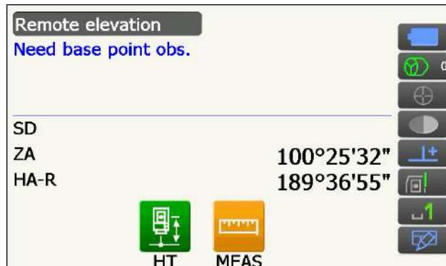
Отобразятся измеренные данные расстояния, вертикальный угол и горизонтальный угол.
