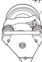
4. Регулируйте регулировочный винт до тех пока, пока натяжение затяжки трех винтов не станет одинаковым, чтобы выровнять пузырек в середине круга.
