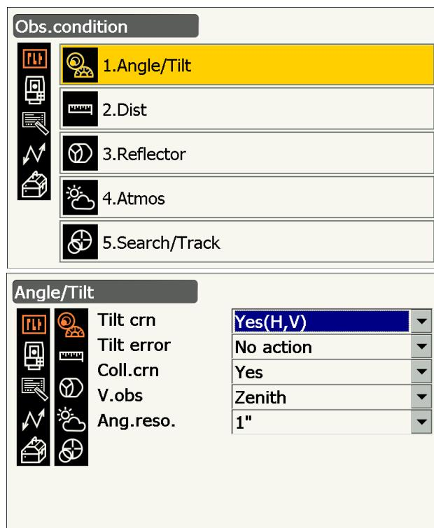
**Задаваемые элементы и варианты выбора (\*: заводская настройка)**Tilt crn (коррекция наклона)  : Yes (H,V)\*/No/Yes (V) (Да (Г,В)\*/Нет/Да (В))Tilt error (ошибка наклона)  : No action\*/Go to <Tilt> (Нет действия\*/Переход к <Tilt>)
