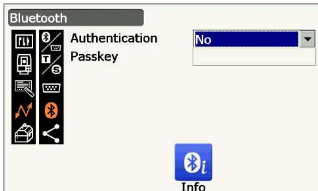
9. Если для «Authentication» (Аутентификация) выбрано «Yes» (Да), введите тот пароль, который предназначен для сопряженного устройства. Даже если для «Authentication» (Аутентификация) выбрано «No» (Нет), потребуется пароль при включении аутентификации на сопряженном используемом устройстве.
