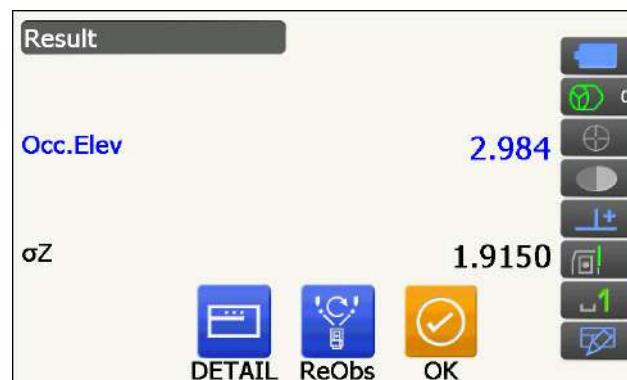
Значения стандартного отклонения для каждой точки отображаются на экране <Detail> (Подробности).
