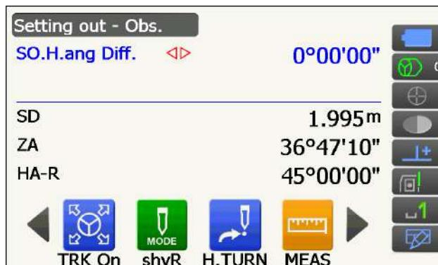
7. Переключитесь на значки управления и нажмите [REM] для начала REM-измерения. Расстояние (разница высоты) и направление перемещения цели будет отображаться на приборе, пока точка визирования и разметочная точка не будут совмещены.
