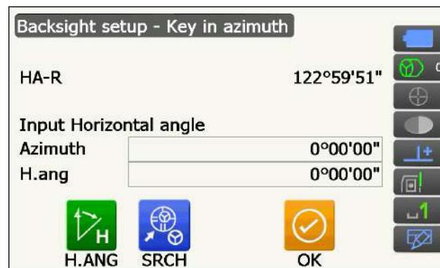
3. Нажмите [OK], чтобы задать введенные значения. Отобразится экран <Coord. measurement> (Измерение коорд.).
