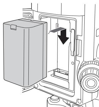
3. Закройте крышку аккумуляторного отсека. При закрывании крышки должен быть слышен щелчок.
