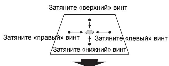
Регулировочная крышка лазерного отвеса обращена к пользователю
