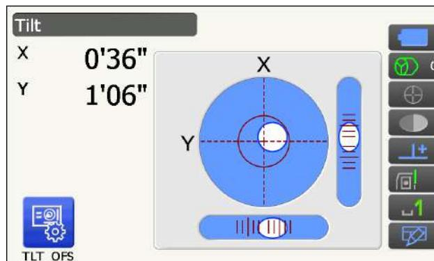
4. Используя винты для выравнивания ножек, поместите «●» в центр круглого уровня. Сначала поворачивайте прибор, чтобы зрительная труба расположилась параллельно линии, образованной юстировочными винтами ножек А и В. Затем установите значение угла наклона на  $0^\circ$  с помощью винтов А и В по оси X и с помощью юстировочного винта С по оси Y.
