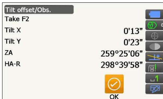
7. Отобразится новая измеренная константа поправки наклона.
