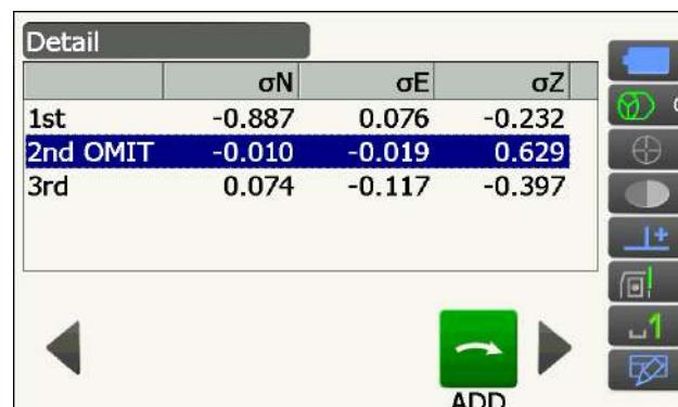
10. Нажмите [OK] на экране <Resection/result> (Обратный замер/результат) для отображения экрана <Resection/Set h angle> (Обратный замер/Установка угла h). Выберите режим угла и нажмите [YES], чтобы задать угол азимута первой известной точки в качестве базисной задней точки и вернуться к экрану <Resection/Menu> (Обратный замер/Меню).
