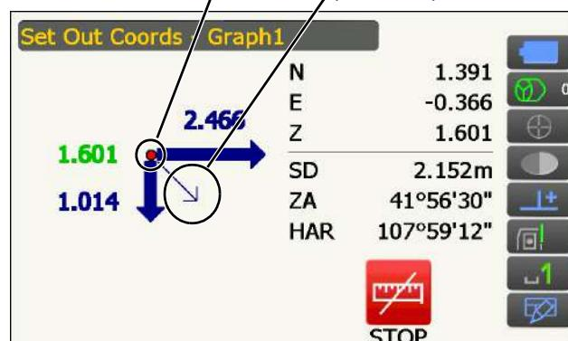
Разметочная точка Положение работающего с мачтой
