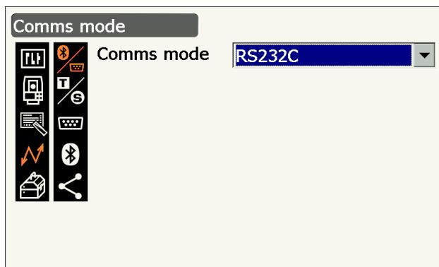
5. Выберите «RS232C» на экране <Communication Setup> (Настройка связи).
