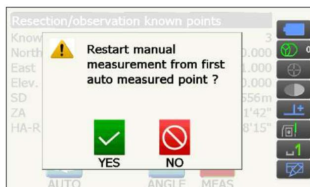
7. Нажмите **[CALC]** или **[YES]** для автоматического запуска расчетов после выполнения замеров всех известных точек. Будут отображены координаты прибора, повышение прибора и стандартное отклонение, описывающее точность измерения.
