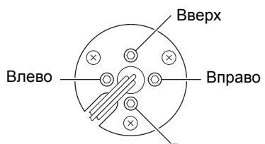
Винты точной регулировки
