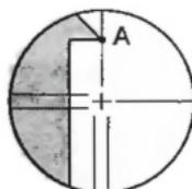
3. Используйте винт точной наводки зрительной трубы для перемещения цели в точку B на вертикальной линии сетки нитей.
