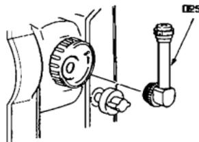
После снятия ручки тахеометра отвинтите закрепительное кольцо и снимите окуляр зрительной трубы. Затем прикрутите на его место диагональную насадку.
