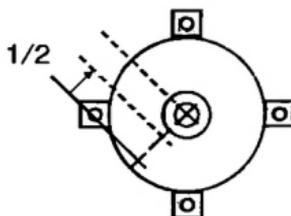
4. Снимите защитную крышку сетки нитей оптического отвеса.
