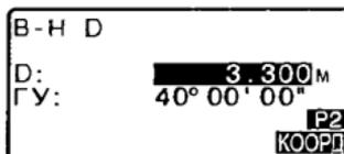
8. Поворачивайте верхнюю часть инструмента до тех пор, пока значение "dГУ" не станет равным 0°, затем поместите отражатель на линию визирования.
