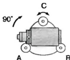
5. Поверните инструмент на  $90^\circ$  и проверьте положение пузырька. Поверните верхнюю часть инструмента еще раз на  $90^\circ$  и проверьте, остался ли пузырек в нуль-пункте цилиндрического уровня. Если пузырек сместился из центра, выполните следующие действия:
