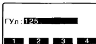
Наведитесь на вторую визирную цель. Выводится отсчет по горизонтальному кругу на вторую визирную цель с учетом установленного отсчета по горизонтальному кругу на первую точку.
