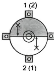
Если точка находится на сплошной линии (пунктирной линии): Слегка ослабьте правый (левый) юстировочный винт и на такую же величину закрутите левый (правый) юстировочный винт, чтобы поместить точку точно в центр оптического отвеса.
