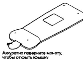
2. Установите две батарейки (размер R03/AAA). Полярность установки изображена внутри отсека.
