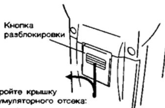
Откройте крышку аккумуляторного отсека: нажмите вниз кнопку разблокировки
