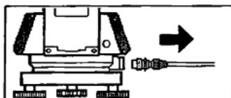
Если к тахеометру подключен кабель для вывода данных на принтер, измерения не могут быть выполнены. Прибор издает звуковые сигналы и выводит на экран показанное выше изображение. После отключения кабеля восстанавливается предыдущий экран.
