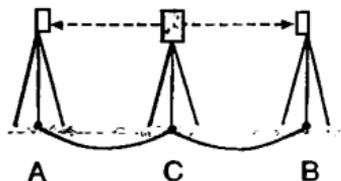
4. 10 раз точно измерьте горизонтальные проложения CA и CB и вычислите средние значения каждого расстояния.
