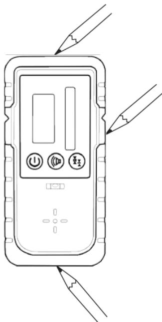
Если линия была проведена по верхней или нижней части приемника, не забудьте ввести поправку, как написано на задней стороне приемника. Приемник должен быть правильно закреплен на плоской вешке в соответствии с исходной меткой.
