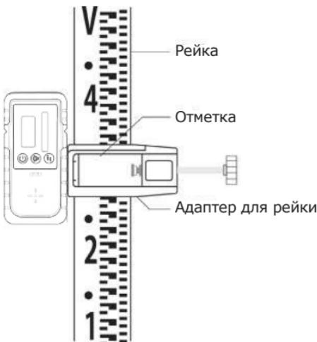
При поиске отметки ослабьте винт крепления и плавно перемещайте адаптер с приемником вверх, вниз по рейке до обнаружения исходной точки.
