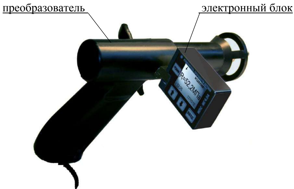
Рисунок 1.1 – Общий вид измерителя прочности бетона ИПС-МГ4.04
