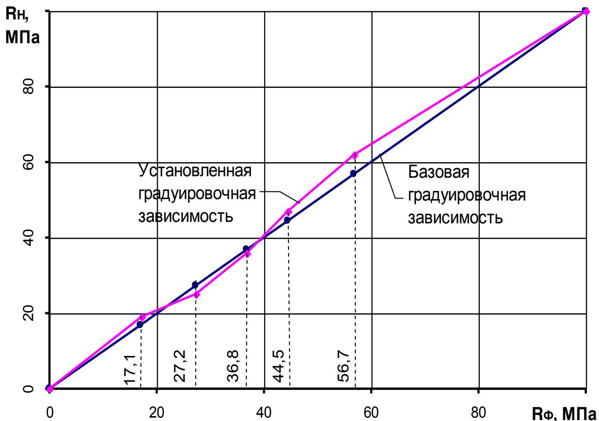
**Примечание -** Индивидуальная градуировочная зависимость может устанавливаться по данным параллельных испытаний одних и тех же участков методом отрыва со скальванием и прибором ИПС-МГ4, при этом средняя квадратическая ошибка градуировочной зависимости  $S_T$ , в соответствии с методическими рекомендациями МДС 62-1.200 (ГУП НИИЖБ), определяется по формуле:
