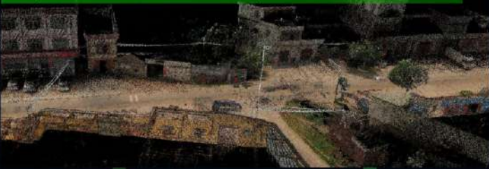
Окрашивание облака точек для простоты дешифрирования
