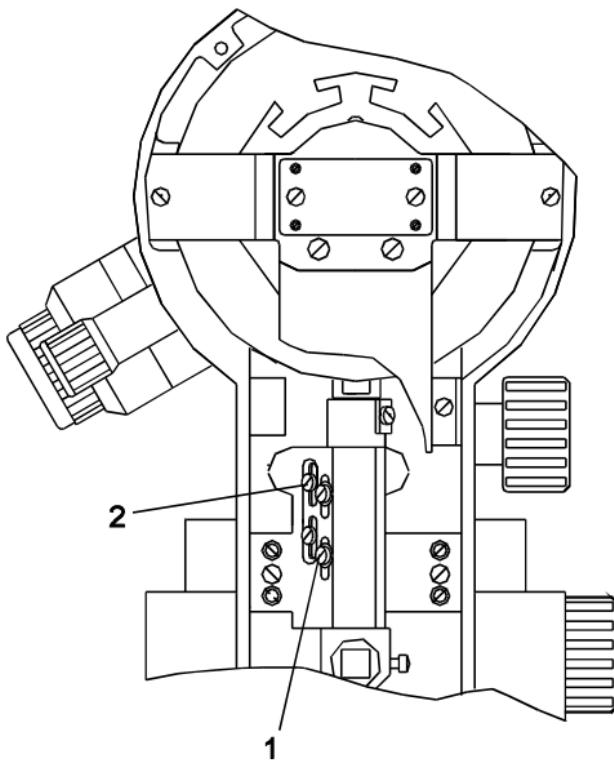
1 - винты крепления линз горизонтального круга;
