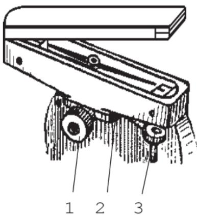
1 - закрепительный винт; 2 - кронштейн; 3- винт арретира
