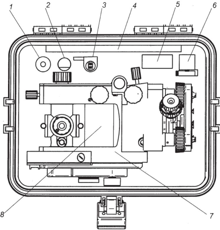
1 - насадка на зрительную трубу; 2 - насадка на микроскоп; 3 - уровень; 4 - паспорт; 5 - инструмент и принадлежности (шпильки, отвертки и масленка) в пакете; 6 - ориентирбуссоль (в случае поставки); 7 - теодолит; 8 - фонарь (допускается укладывать на крышке футляра) или фонарь (в случае поставки)
